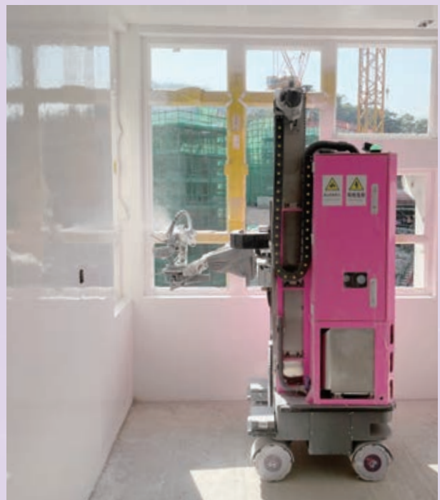
在公营房屋项目中试用油漆机器人 A painting robot trial in a public housing project
