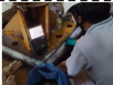
檢測顧問進行磁粉、超聲波及目測檢視工字秤腳焊接位置
