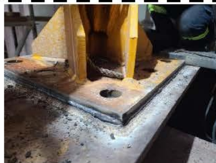
檢測顧問進行磁粉、超聲波及目測檢視工字秤腳焊接位置
