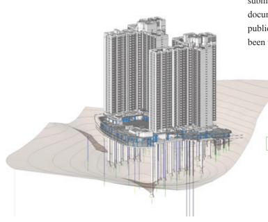
建筑信息模拟驱动的系统化地基设计 BIM-SAFD
