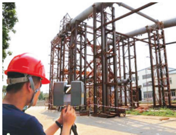
坐地式雷射測量技術 Terrestrial laser scanner
