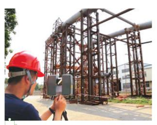
坐地式雷射測量技術 Terrestrial laser scanner
