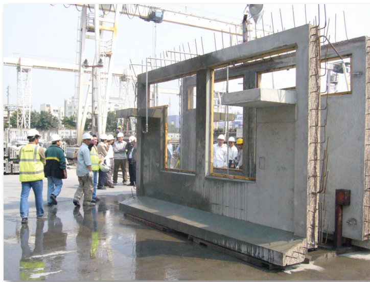
预制混凝土外墙以矿渣微粉取代部分水泥
