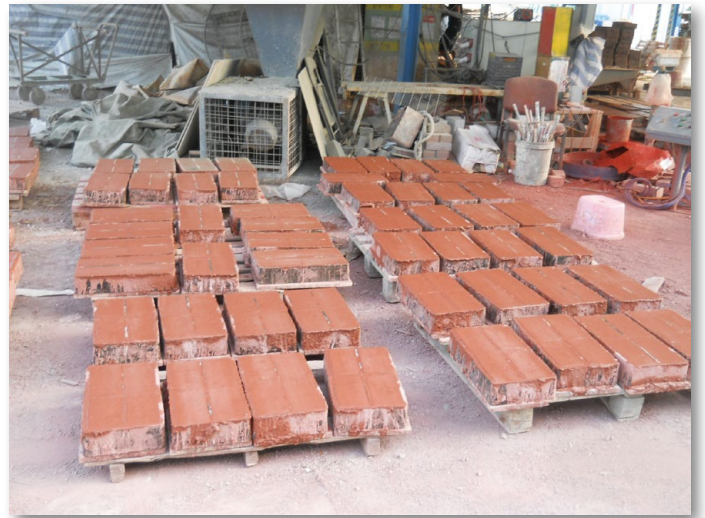
以水泥加固海泥制造的铺路砖
