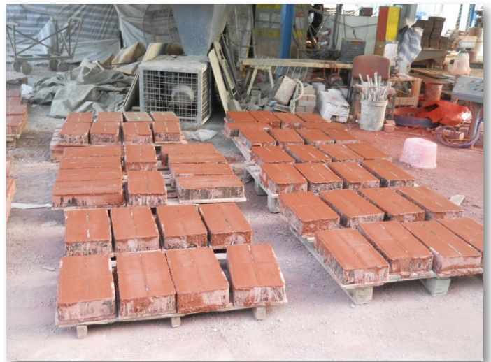
以水泥加固海泥製造的鋪路磚
