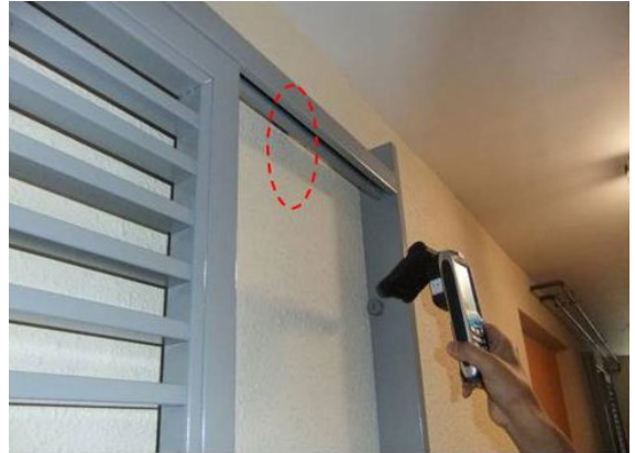
使用無線射頻識別系統識別鐵閘
