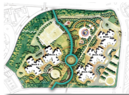
将楼宇建筑位置移后减少噪音受体的声浪水平
