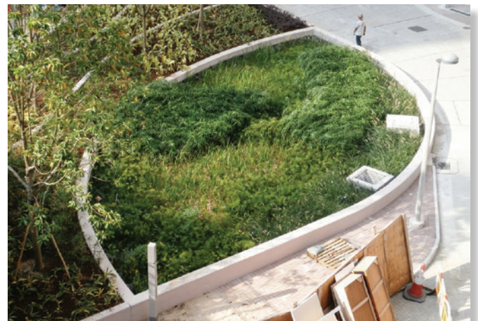
零灌溉種植系統利用毛細管作用，直接輸送儲存在地下儲水箱的雨水灌溉植物
