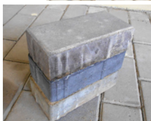
▲ 以回收玻璃碎石制成混凝土路砖的应用（上图及下图）
