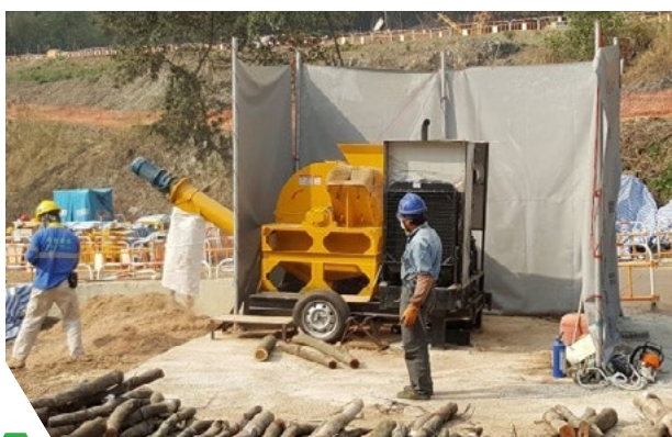
砍伐后的树木，被分割及切碎成木屑，并与食物及园林废物搅拌，制成园艺盖土
