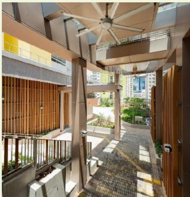
基于微气候研究的结果，在室外加装天窗及大风量低速吊扇，以提高人体舒适度
