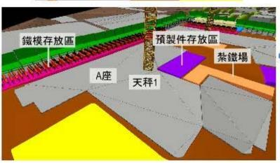
建造資訊模型(BIM)顯示工地內不同的工作區域。透過BIM,可以應用在入職安全訓練上,向新入職員工介紹工地設備位置,使他們更易瞭解和掌握工地狀況。
