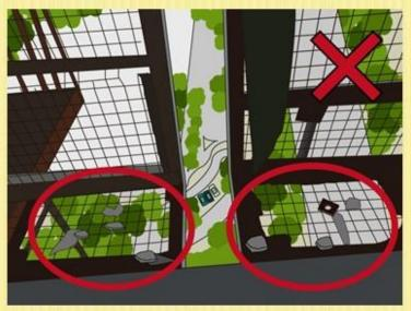
楼高七层以上的建筑没有安装保护檐篷 PROTECTIVE CANOPY WAS NOT INSTALLED FOR A STRUCTURE OF 7 OR MORE FLOORS.
