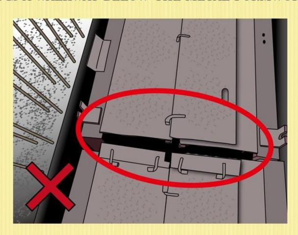
应将外墙铁模平台上的杂物碎料清走 DEBRIS AND LOOSE MATERIALS SHOULD BE CLEARED FROM THE EXTERNAL WALL METAL PLATFORM
