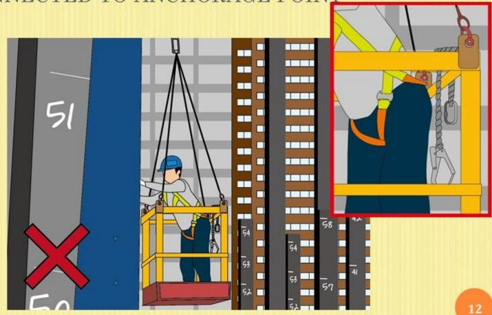
有眼螺栓的方向應與拉力方面一致 THE EYEBOLT SHOULD BE ORIENTED IN LINE WITH THE INTENDED LINE OF FORCE OF THE INDEPENDENT LIFELINE
