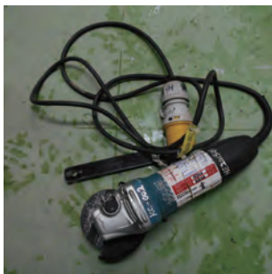
应使用低压电力手提工具 Use low voltage portable tools
