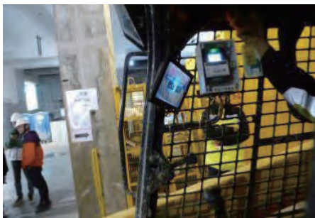
在小型装载搬土机安装倒车摄影机 Reverse camera installed to mini/skid loader
