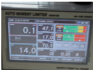
安全负重显示器自动将不安全载荷的吊运作业发出警告 Automatic safe load indicator to alert unsafe lifting
