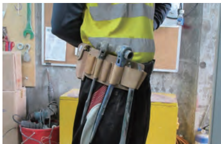
利用腰带工具套稳妥地携带手提工具 Carry handheld tools securely with waist gear
