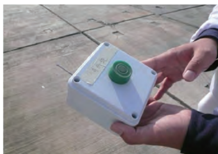
為較遠工作／儲存位置可提供流動式手動火警鐘 Portable manual fire alarm call point suitable for remote location
