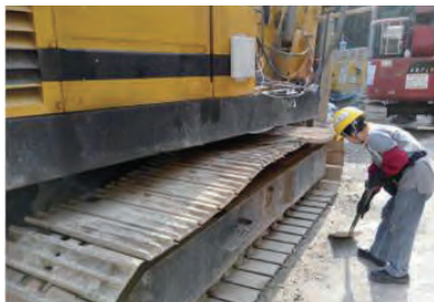
挖土機的兩側和後面裝上無線射頻識別感應器，而進入危險範圍工作的人員會獲發無線射頻識別標籤
