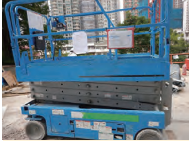
在離地高於2米的地方工作，必需使用工作平台 Use working platform for working at height of 2 meters or above
