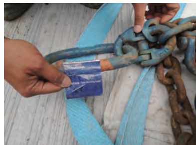
應使用有顏色標示的鏈吊索 Colour code applied for chain sling
