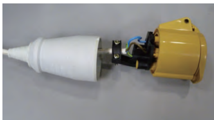
插座內的電線應妥善接駁於接線座，電線不得外露
