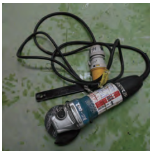
應使用低壓電力手提工具 Use low voltage portable tools
