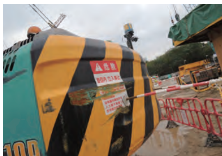
在挖土機尾部安裝閉路電視攝影機 CCTV installed at the rear part of Excavator
