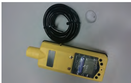
使用經過校準的氣體探測器量度密閉空間內有毒／易燃氣體的濃度
