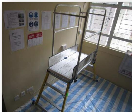
15. 護欄應位於距工作台 450 - 600 毫米和 900 - 1 150 毫米高處，並形成一道屏障，以防止站在工作台台上的工人墮下。
