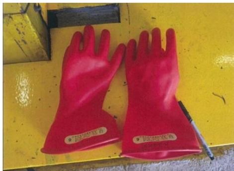
電工適用的絕緣手套
