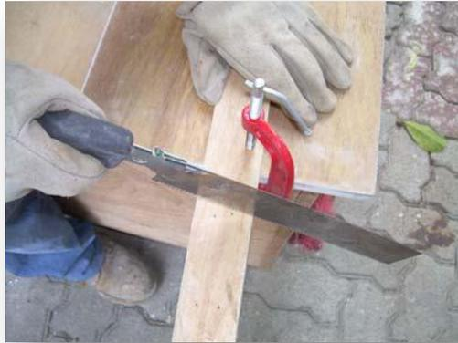
6. 使用手提鋸前，應先以夾鉗或弓形夾將容易移位的工件鎖緊。
