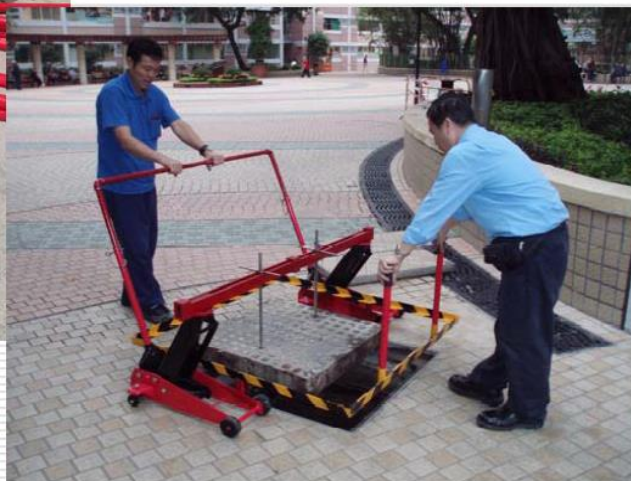
第二代重型起渠蓋機 (安全可靠起渠蓋機) 職安健新創建
