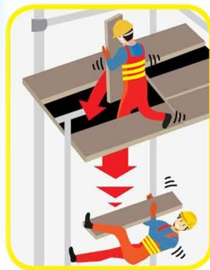
工人從槽內之棚架墮下
