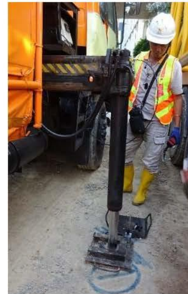
Firm Ground Tester 地面硬度測試機
