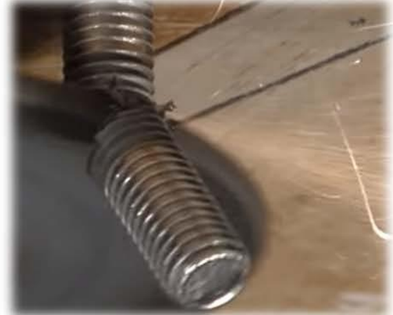
砂輪切割絲桿時產生火花
