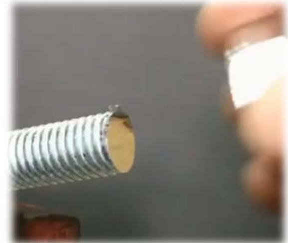
砂輪切割絲桿時產生“披鋒”
