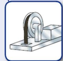
3. 加裝防止機廂向上超速裝置
