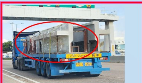
以存放架穩固承托預製件
