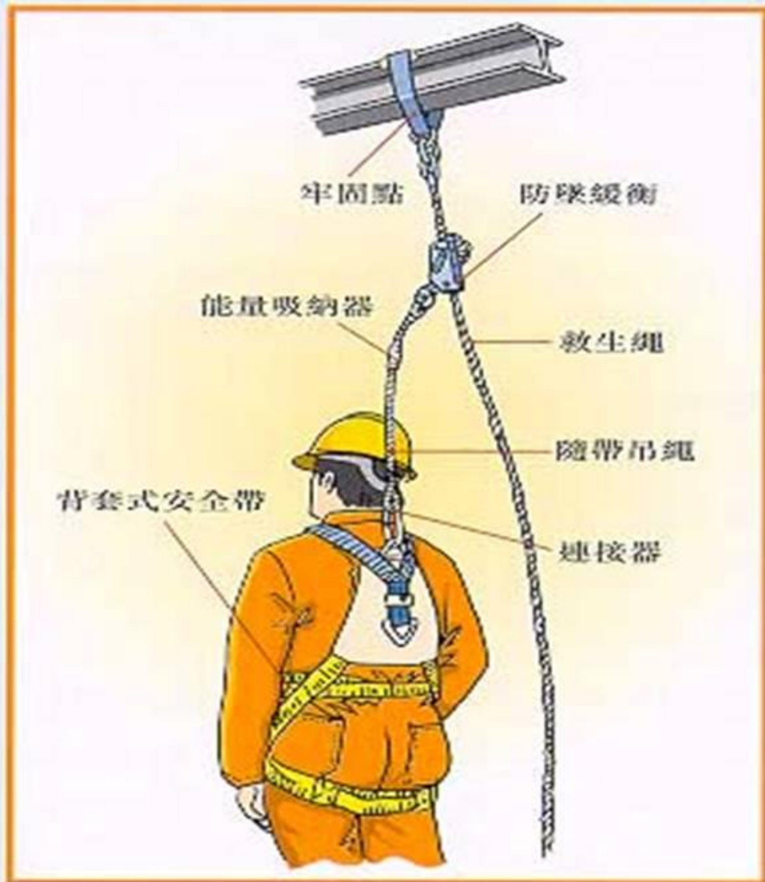
高空工作的個人抗墜防護系統
