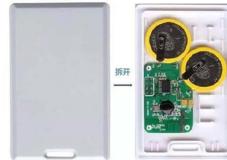
內置了鈕扣電池的RFID標籤
