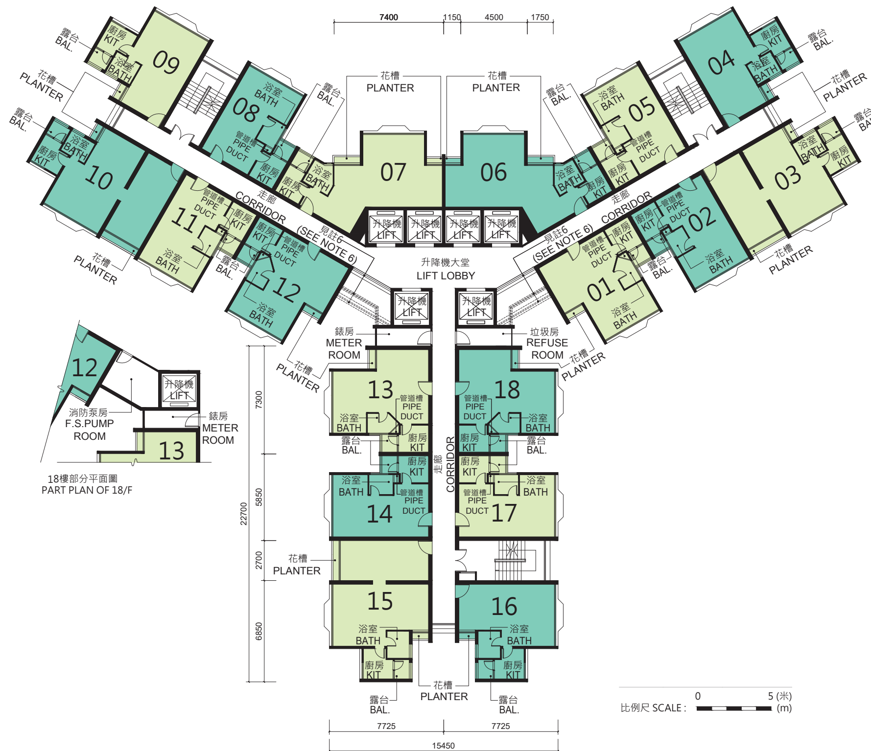
裕生樓(第4座) 3樓至35樓平面圖 YUE SANG HOUSE (BLOCK 4) 3/F-35/F FLOOR PLAN
