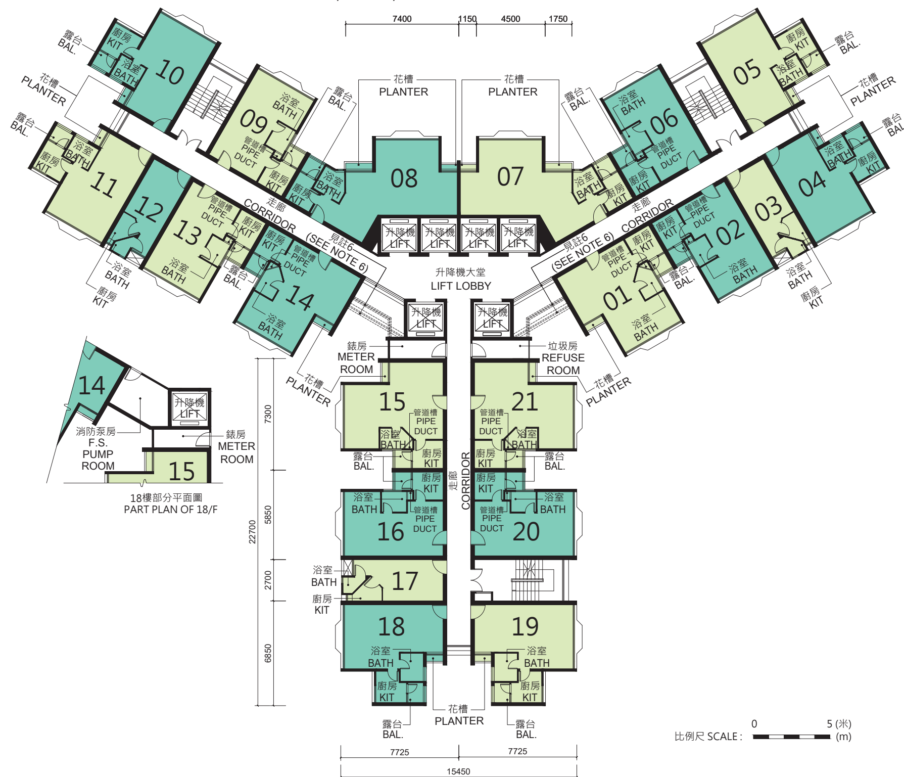
泰生樓(第6座) 3樓至35樓平面圖 TAI SANG HOUSE (BLOCK 6) 3/F-35/F FLOOR PLAN
