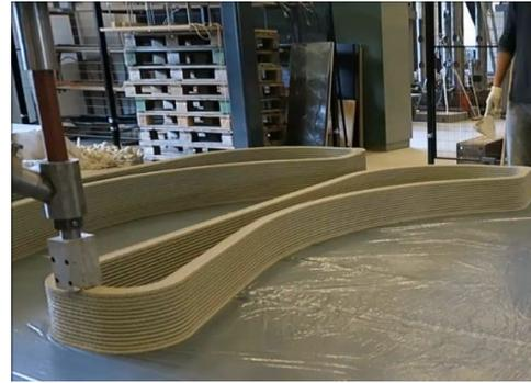
混凝土 3D 打印制成品。
