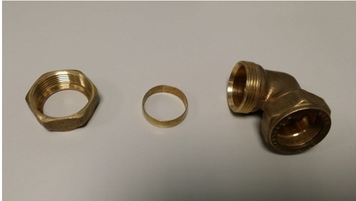
(b) 單位內：以壓合接頭方式接駁的銅喉
