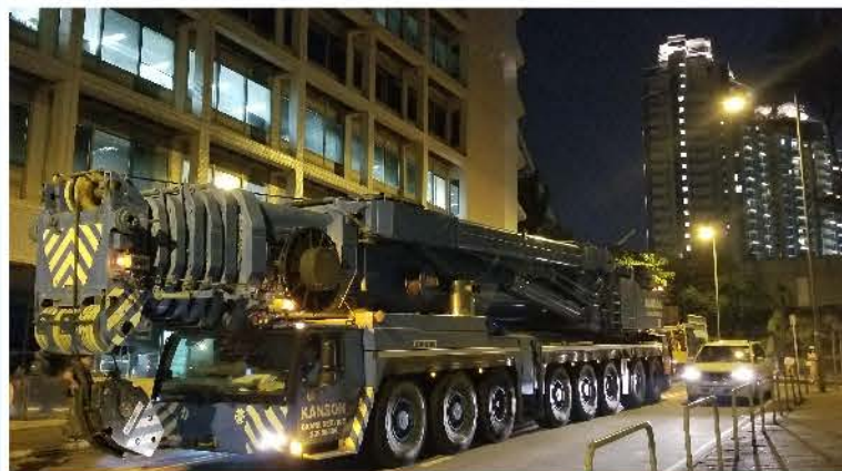
500噸大型吊臂車未組裝前的狀態
